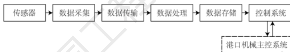
图4 智能集中润滑系统示意图
